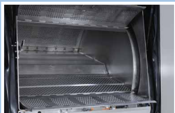
Inclinación suave de la partición y puerta puente
